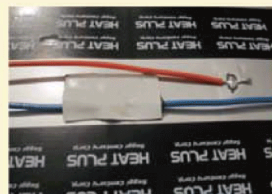
7. 鉛部分をBUTYLテープにて絶縁 (裏面も絶縁テープで処理)
